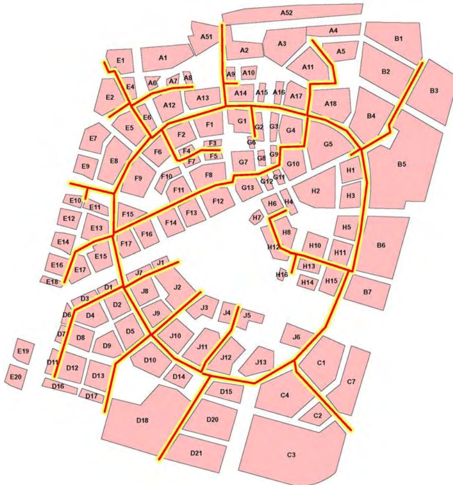
Abbildung 45: Mögliche Trassenverlegung für die Fernwärme (N.B.: die bestehende Fernwärmeleitung, die quer durch den südlichen Teil der Seestadt verlegt ist, ist dabei nicht dargestellt)
