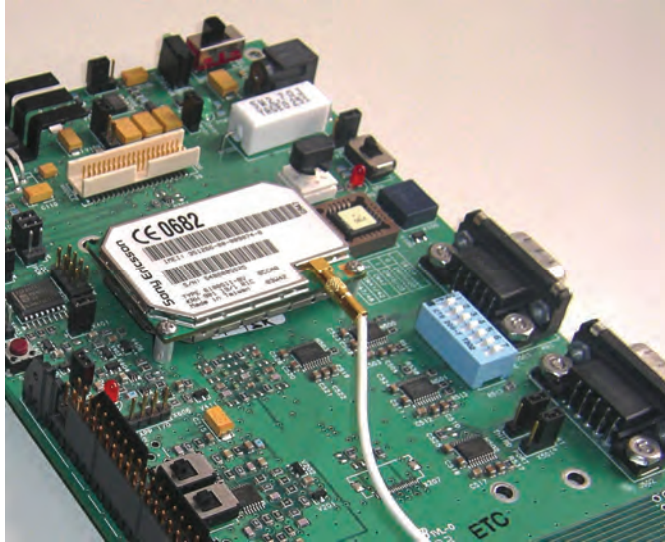
Abbildung 24: Das GR47 GSM Modul auf dem dazugehörigen Development Board.
