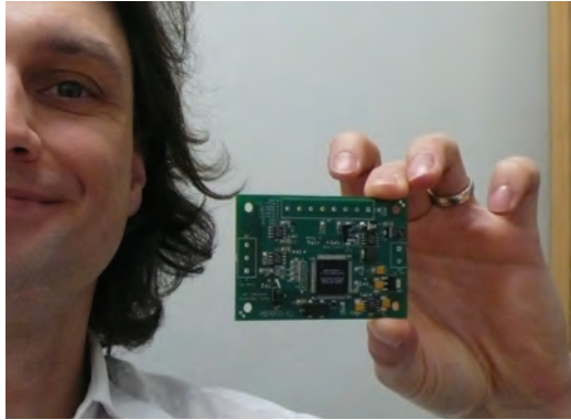
Abbildung 44: Der GridWise™ GridFriendly™ Appliance Controller schaltet Lasten ab einer Frequenzuntergrenze ab. Bildquelle: eigene Aufnahme.
