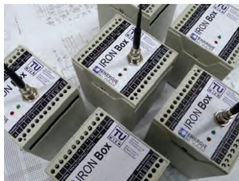
Die IRON-Box dient als Interface zwischen Infrastruktur (GSM/WLAN) und Verbrauchsgerät
