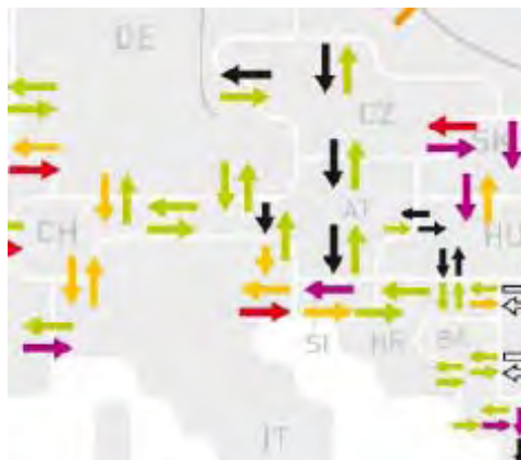
Abbildung 48. Engpässe an den grenzüberschreitenden Übertragungsleitungen von und nach Österreich im Jahr 2007. Die schwarzen Pfeile repräsentieren eine zu 100% ausgelastete Leitung. Quelle: UCTE (2008)
