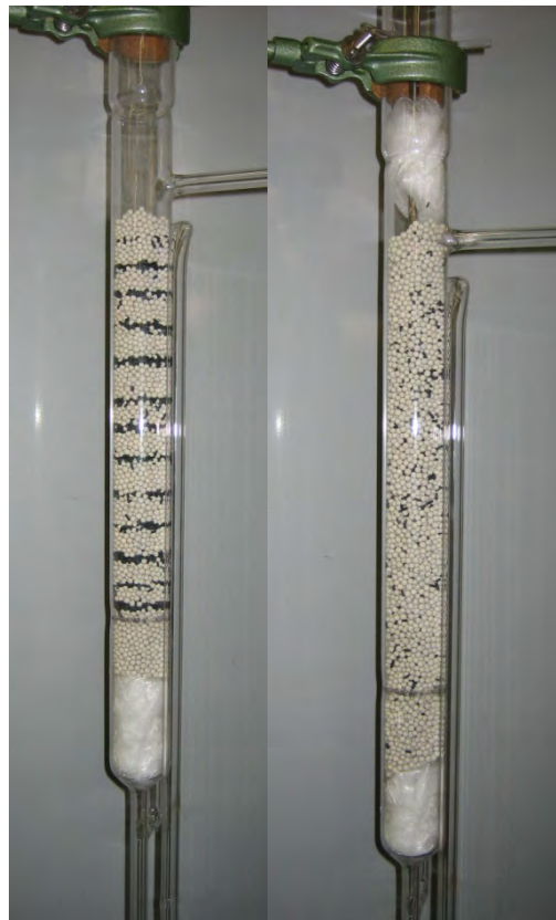
Abbildung 4.19: Links: Schichten von Katalysator und Inertmaterial; rechts: die Mischung
