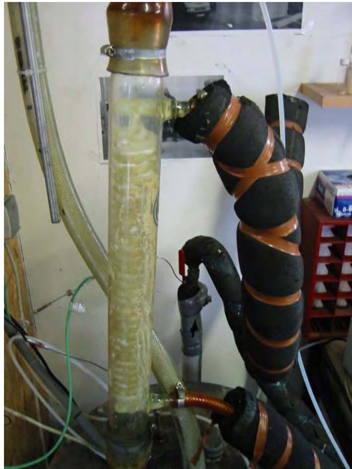
Abbildung 3.12: Glaswärmetauscher mit Doppelwendel
