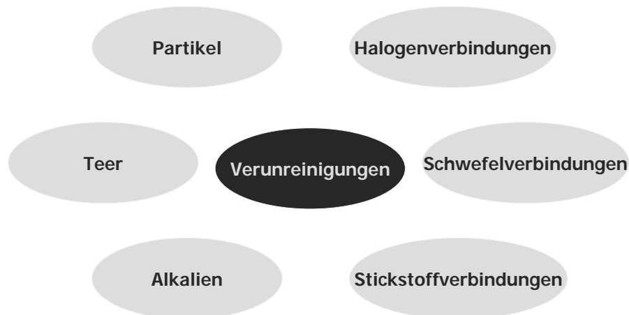
Abbildung 7.3: Verunreinigungen im Produktgas der Biomassevergasung
