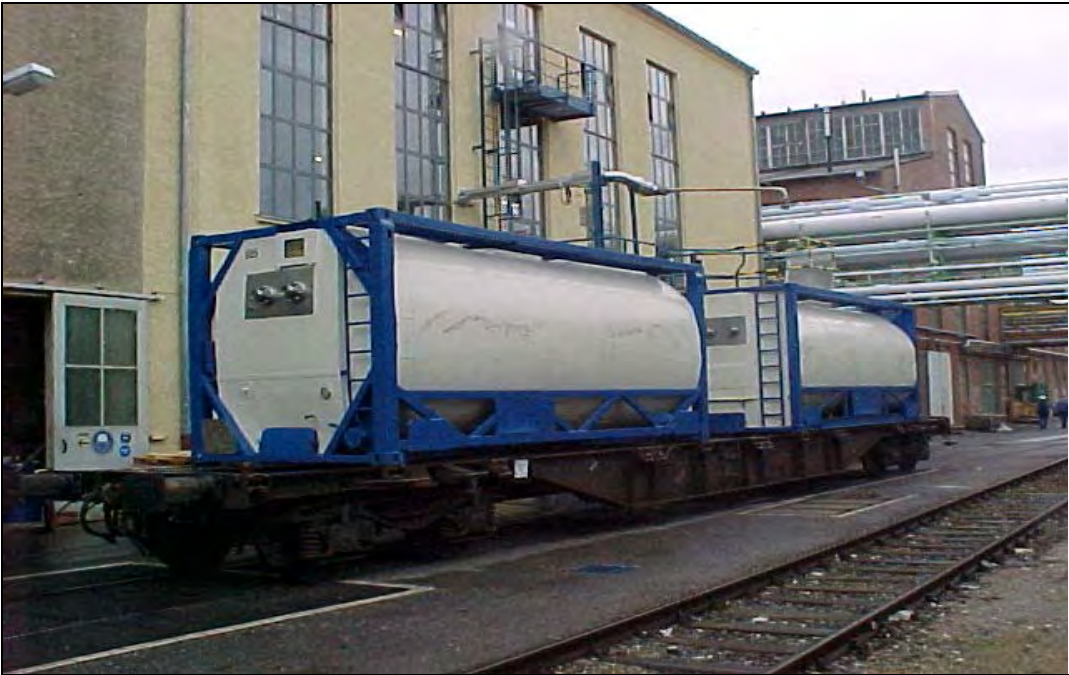
Abb. 10: LWS-System Fa. Transheat GmbH
