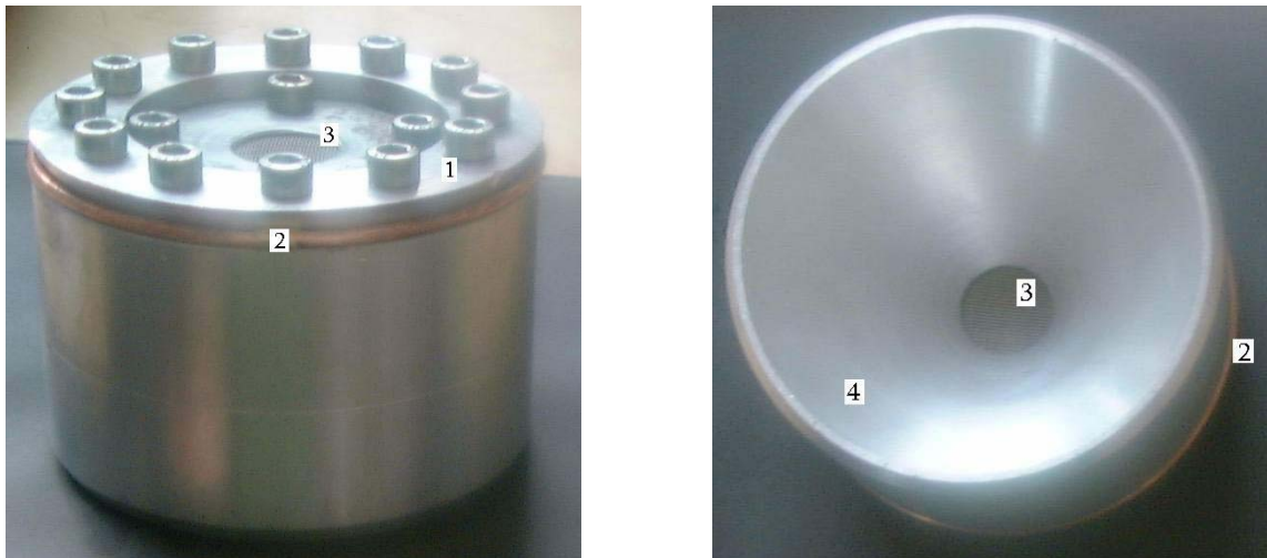
Abbildung 3-23: Düsenboden mit Kupferdichtung und Metallfilter
