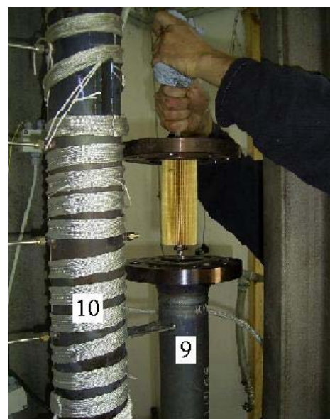
Abbildung 3-24: Partikelfilter für Katalysator und FT-Produkt-Auslass
