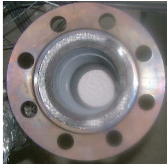
Abbildung 3-14: Schema Adsorptions-Reaktor und eingefülltes \text{NaAlO}_2
