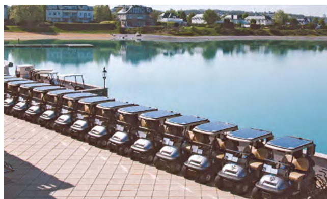
Abb. 10: Solarauto von Sono Motors mit integrierter Photovoltaik Abb. 11: Das bestehende Dach des Golfwagens kann durch die leichte und dünne Konstruktion des Photovoltaikmoduls selbst Strom produzieren.
